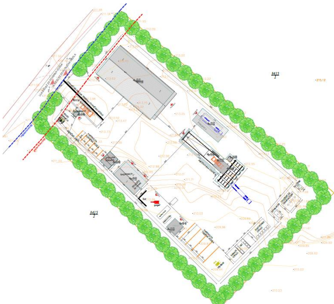
Илустрација 50. Могуће пројектно решење трансфер станице Књажевац
